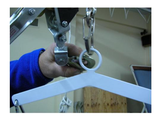
Sujeción de silla de ruedas desmontable para vehículos
